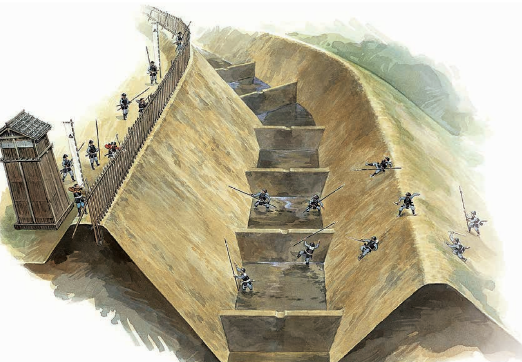
総構の障子堀 障子堀とは、堀の内部に障壁を掘り残した構造の堀のことです。約2メートルもの高さの障壁で斜面でも水堀(泥堀)になり、堀に落ちたらほぼ逃げられず敵の動きを封じる効果がありました。(図版提供:小田原市)
